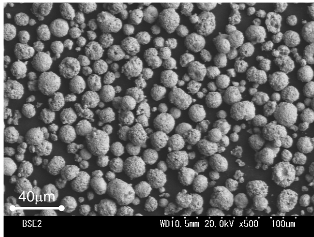
図1. WC-Fe 基溶射材料 (-20+5 \mu m 粒度の造粒焼結粉) の電子顕微鏡写真
