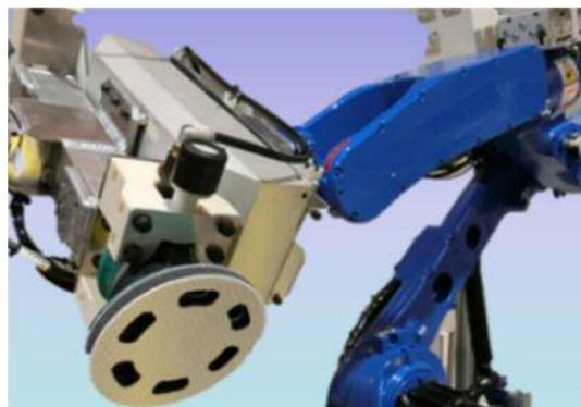
ロボット研磨用材料・プロセス技術
